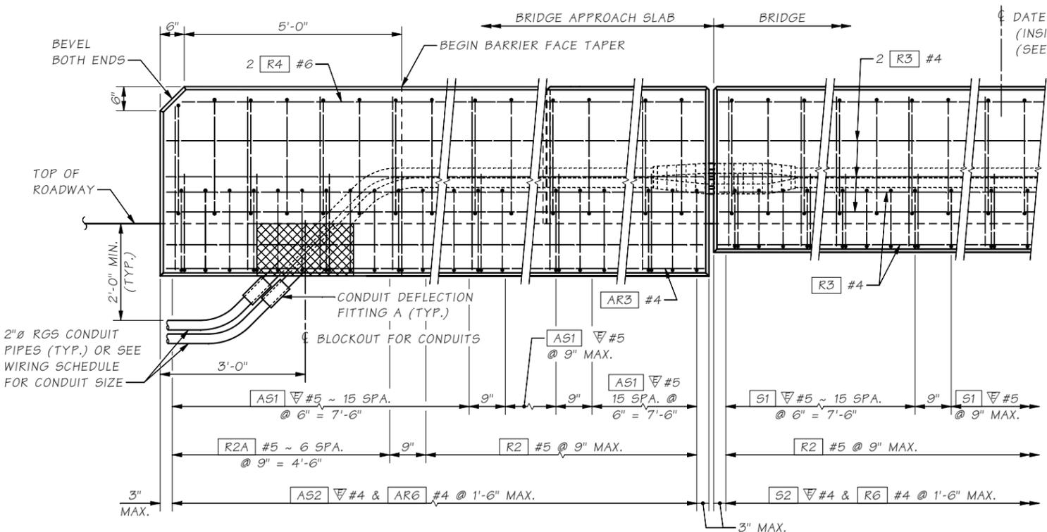
**OUTSIDE ELEVATION END OF TRAFFIC BARRIER**
