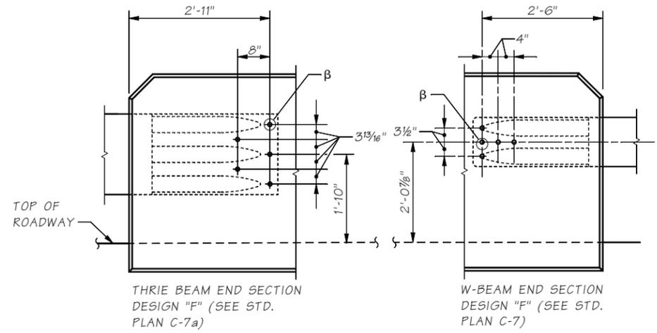
**OUTSIDE ELEVATION TRAFFIC BARRIER - GUARDRAIL CONNECTION**
